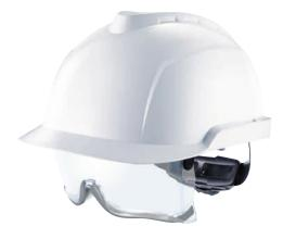
Protección de la cabeza equilibrada, moderna y de perfil bajo con protección ocular integrada, todo en un solo producto sin ventilación, con atalaje de 6 puntos y trinquete Fas-Trac® III, gafas integradas con ajuste inteligente e innovadora junta de goma. Para el uso donde exista riesgo de impactos superiores en la cabeza, así como riesgo de impactos, rayos UV y polvo para los ojos.
