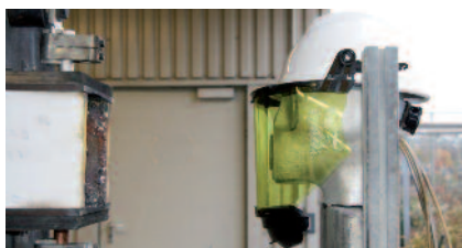
Set MSA di protezione contro l'arco elettrico prima del test a 7 kA
