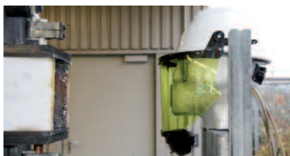
Conjunto contra arco eléctrico de MSA antes del "ensayo de arco en caja" 7 kA
