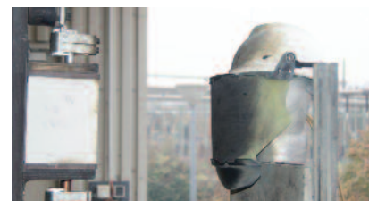
Certificación GS-ET-29 clase 2-7 kA. La combinación de protección facial y de la cabeza para el usuario.
