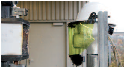
MSA Elektrikerset vor "Prüfung mit Open Box", 7 kA
