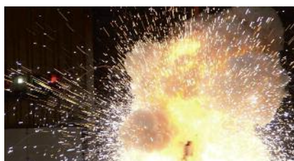
Arc flash 7 kA
