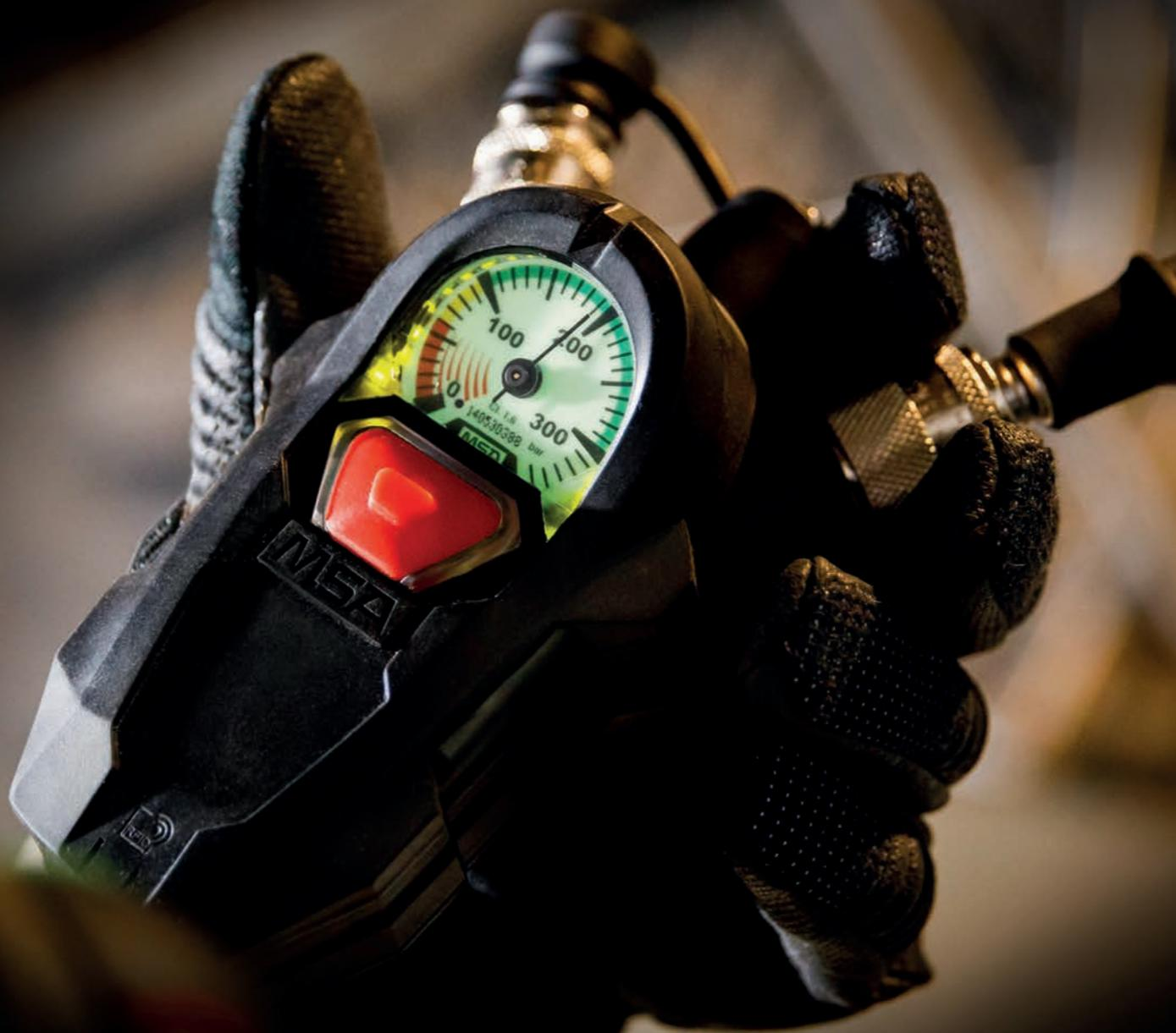
*L'unité de contrôle avec détecteur d'immobilité intégré MSA SLS remplit 3 fonctions principales : contrôle de pression de la bouteille, détection d'immobilité et enregistrement de données. Elle peut facilement être intégrée à tous les ARI MSA AirGo et AirMaXX disposant du système pneumatique «SingleLine». Cette technologie unique permet de combiner la moyenne et haute pression dans le même tuyau.*
