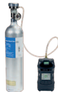
Manuell testning med testgas
