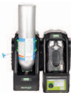
GALAXY GX2 automatiserad testbänk
