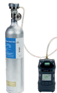
Test manuale con gas di prova
