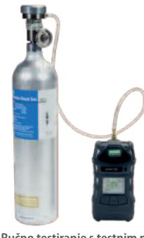
Ručno testiranje s testnim plinom
