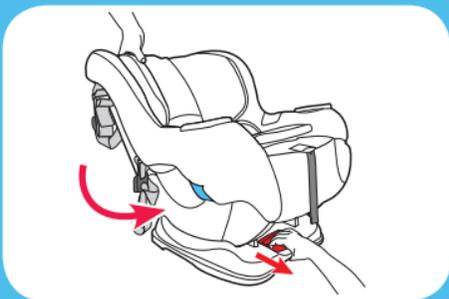
**3. Asegúrese que la correa del LATCH esté en la vía del cinturón orientada hacia atrás marcada con una etiqueta azul**
