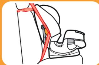
***Cinturón de seguridad para la falda y los hombros con sistema de fijación***
