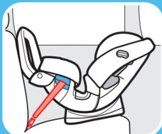
**Acoplamiento de anclaje inferior**
