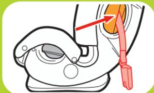
**5. Asegúrese de que la correa de anclaje inferior esté en la vía del cinturón orientada hacia adelante marcada con una etiqueta de color naranja**
