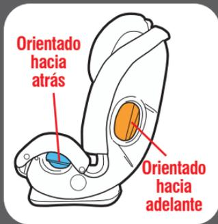
**5. Empuje los conectores de anclaje inferior a través de las aberturas de la vía del cinturón orientadas hacia atrás a cada lado del asiento de automóvil**
