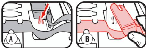
**4. Deslice toda la correa de anclaje inferior a lo largo de la barra hacia las aberturas deseadas en la vía del cinturón**
