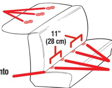
Asiento típico de un vehículo de pasajeros. Otros tipos de vehículos podrían tener el anclaje inferior y el anclaje del sistema de fijación en otros lugares.
