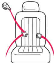
**Cinturón de seguridad para la faldita y el hombro** 3 puntos de conexión. Se puede usar en todos los modos de uso del asiento de automóvil.
