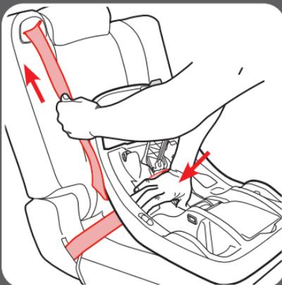
**Nota:** Cuando usa la base, elimine toda la flojedad del cinturón de seguridad. La traba sujeta el cinturón de seguridad.
