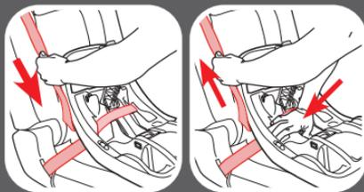
**Nota:** Con el cinturón de seguridad del vehículo en este modo trabado, toda la tensión está arriba en el cinturón de seguridad del vehículo para el hombro. Esto podría comenzar a inclinar el base del asiento de automóvil hacia el costado. Si ocurre, use una presilla de seguridad en lugar de trabar el retractor. Consulte la sección Placa de seguridad deslizante y retractor ELR.
