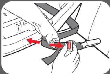
**2. Oprima y mantenga oprimido la botón de liberación del Acoplamiento de anclaje inferior**
