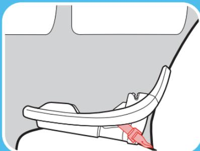
**Correa del acoplamiento de anclaje inferior**
