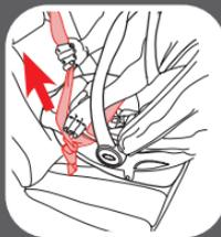
**Nota:** Con el cinturón de seguridad del vehículo en este modo trabado, toda la tensión está arriba en el cinturón de seguridad del vehículo para el hombro. Esto podría comenzar a inclinar el asiento de automóvil hacia el costado. Si ocurre, use una presilla de seguridad en lugar de trabar el retractor. Consulte la sección Placa de seguridad deslizante y retractor ELR.
