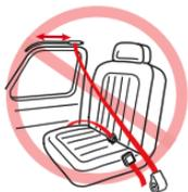
Cinturón para la falda con cinturón motorizado para el hombro
