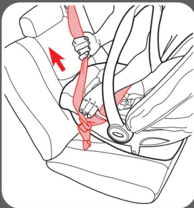
**Nota:** Cuando usa la base, elimine toda la flojedad del cinturón de seguridad. La traba sujeta el cinturón de seguridad.
