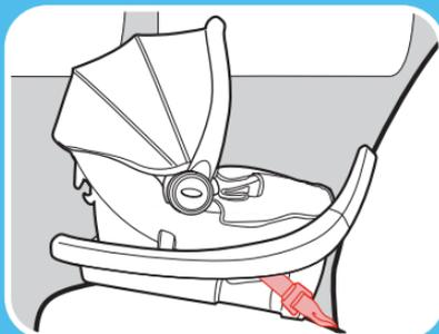
**Correa del acoplamiento de anclaje inferior**
