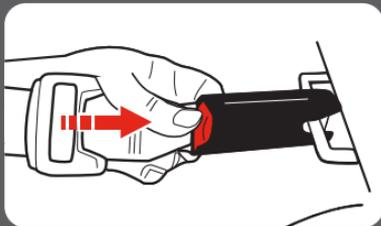
**2. Oprima y mantenga oprimido la botón de liberación del Acoplamiento de anclaje inferior**
