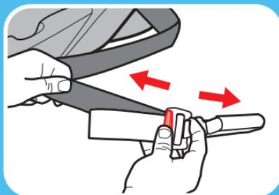
**4. Pase la correa del Acoplamiento de anclaje inferior por la vía del cinturón orientada hacia atrás marcada con una etiqueta esbozada de azul**
