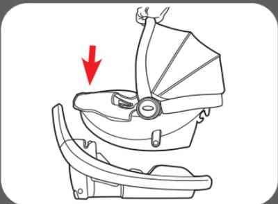
Tire hacia arriba de las esquinas delanteras del asiento para tener la seguridad de que esté trabado.
