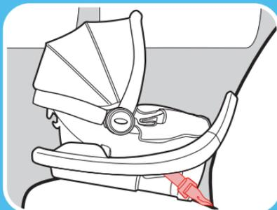
**Correa del acoplamiento de anclaje inferior**
