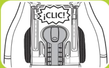
**8. Sujete los conectores del acoplamiento de anclaje inferior a los anclajes inferiores del vehículo.**
