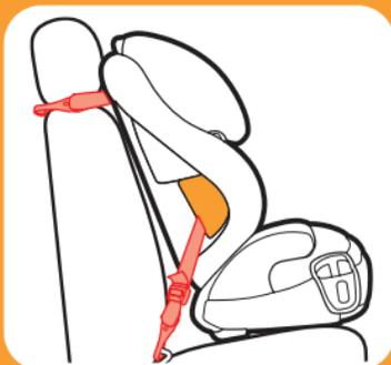
**Acomplamiento de anclaje inferior con el sistema de fijación**
