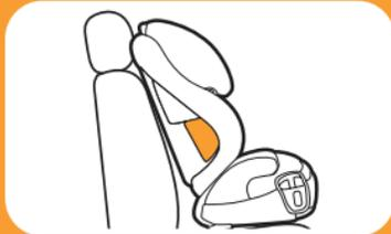
**1. *Guarde la correa del acoplamiento de anclaje inferior***
