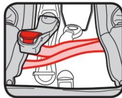
Asegúrese de que el cinturón de seguridad del vehículo esté delante de la correa de hebilla cuando la hebilla está en la posición más interior, y detrás de la correa cuando está en posición más exterior.
