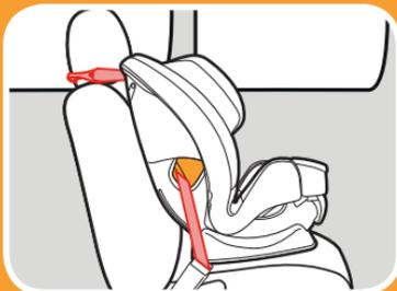
***Cinturón de seguridad para la faldita con la sujeción superior***
