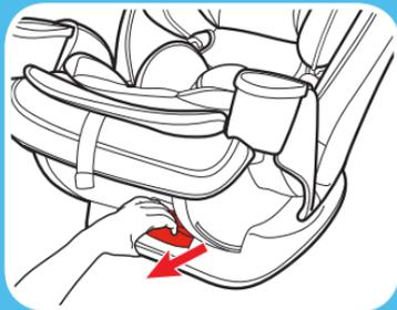
**3. Asegúrese que la correa de los anclajes inferiores esté en la vía del cinturón orientada hacia atrás marcado con una etiqueta azul**
