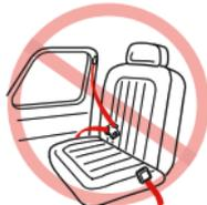
Cinturón para la falda o cinturón para el hombro montado en la puerta
