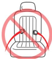
Cinturón para la falda solamente 2 puntos de conexión.
