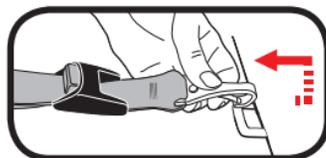
**LATCH** Empuje el botón gris mientras tira la correa del LATCH para aflojarla. Oprima el resorte del gancho. Empuje el gancho hacia dentro, levántelo, gírelo y tire hacia afuera en el sentido opuesto al punto de anclaje.
