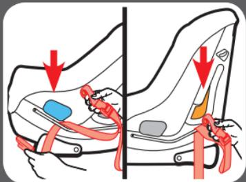
**2. Deslice toda la correa del LATCH a lo largo de la barra hacia la abertura correcta de la vía del cinturón**
