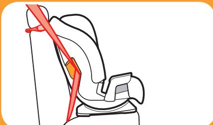
**Cinturón de seguridad para la falda y el hombro con correa de sujeción superior**
