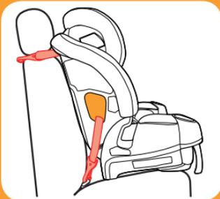
**Correa del LATCH con la correa de sujeción superior**
