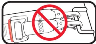
**! No conecte nunca dos ganchos del sistema LATCH a un punto de anclaje inferior del vehículo a menos que el fabricante del vehículo lo especifique.**
