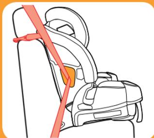
***Cinturón de seguridad del vehículo para la falda y el hombro con la correa de sujeción superior***
