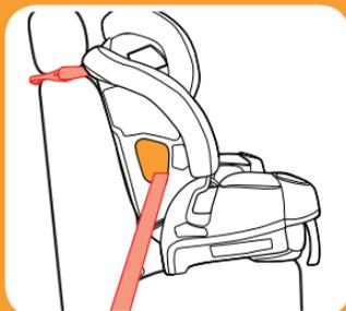
***Cinturón de seguridad del vehículo para la falda con la correa de sujeción superior***
