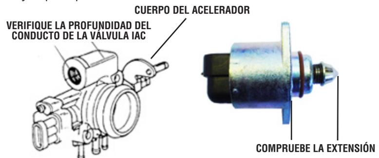
Si el eje se extiende excesivamente, interferirá con el montaje correcto de la pieza.
