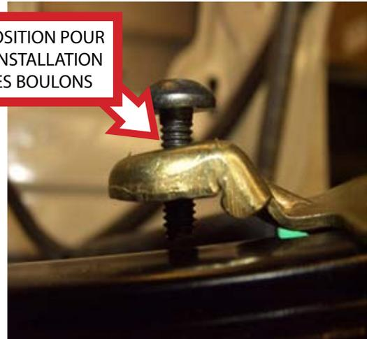
**ÉTAPE 6 :** Installez le rail gauche (côté près de l'arrière du véhicule) à l'intérieur des fentes d'installation en trou de serrure de la porte – **NE SERREZ PAS LES BOULONS!**
