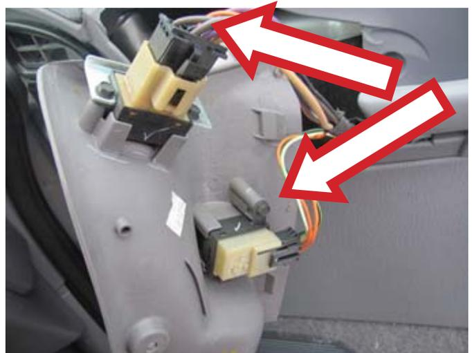
**ÉTAPE 4 :** Enlevez la vis du panneau de la garniture de porte située à l'arrière de l'assemblage du commutateur d'alimentation principal (juste à l'arrière de la poignée de porte).
