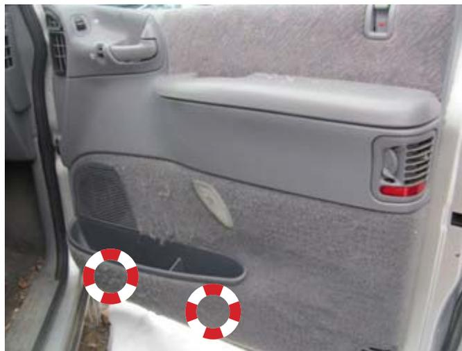
**ÉTAPE 2 :** À l'aide d'une pioche ou d'un petit tournevis à lame plate, enlevez le couvercle de la vis de fixation de l'encadrement.
