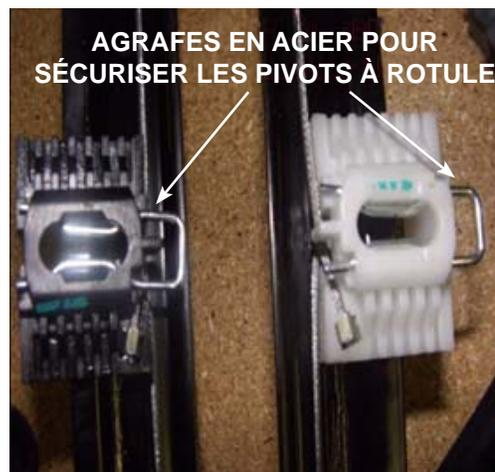
TIREZ LE PIVOT À ROTULE SUR LA VITRE AU-DESSUS DE L'AGRAFE EN ACIER SUR LE CÔTÉ DE LA VITRE
