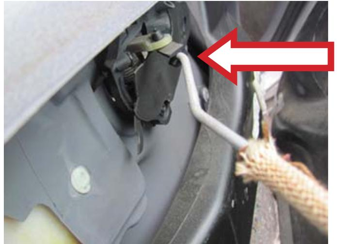
**ÉTAPE 8 :** Débranchez le connecteur de la lampe d'accueil. **REMARQUE :** Pour débrancher le connecteur, poussez l'agrafe de verrouillage rouge pour déverrouiller le connecteur électrique.
