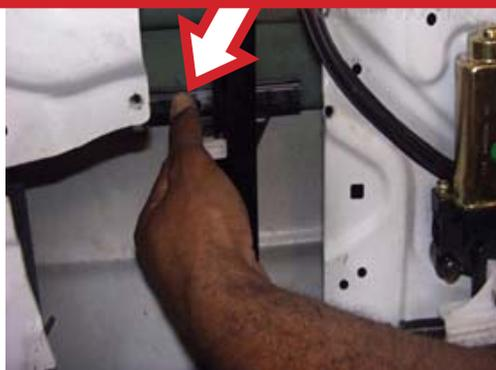
**ÉTAPE 11 :** Placez votre main sur le dessus de la vitre et tirez-la fermement vers la gauche du cadre de la porte et à l'intérieur du guide-vitre.
